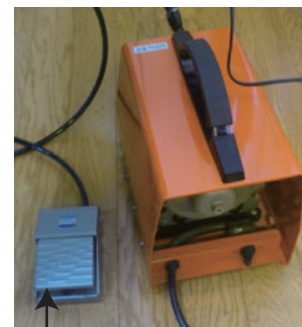
真空ポンプ電源
